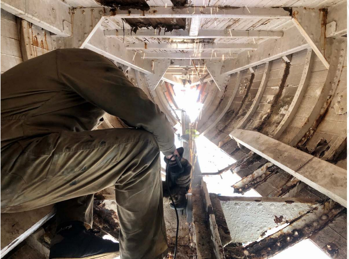
Meury cortando la quilla oxidada y el carril del mástil © Rhonasailing
