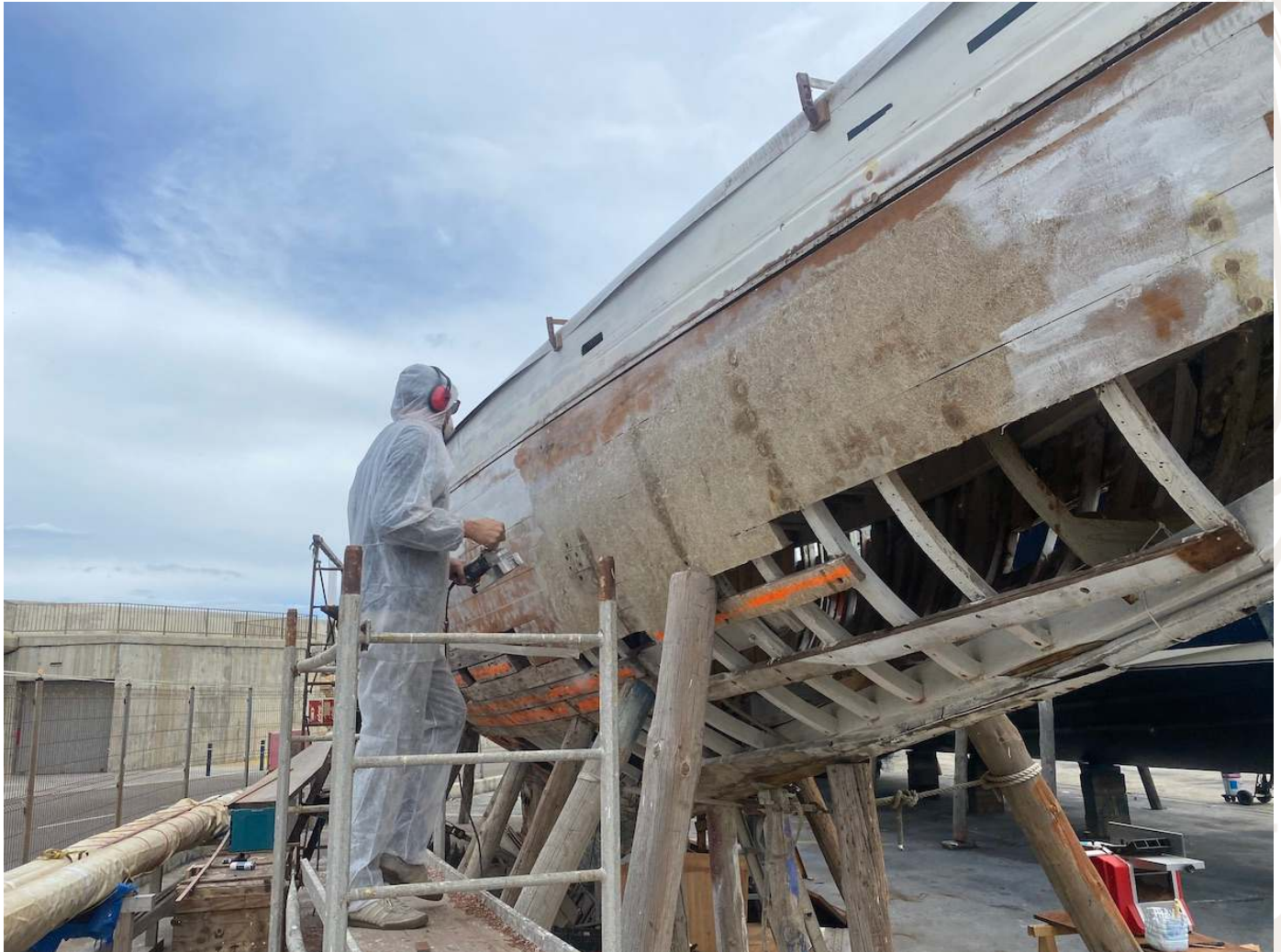
El revestimiento de PRFV se retira lámina a lámina con un cepillo © Rhonasailing
