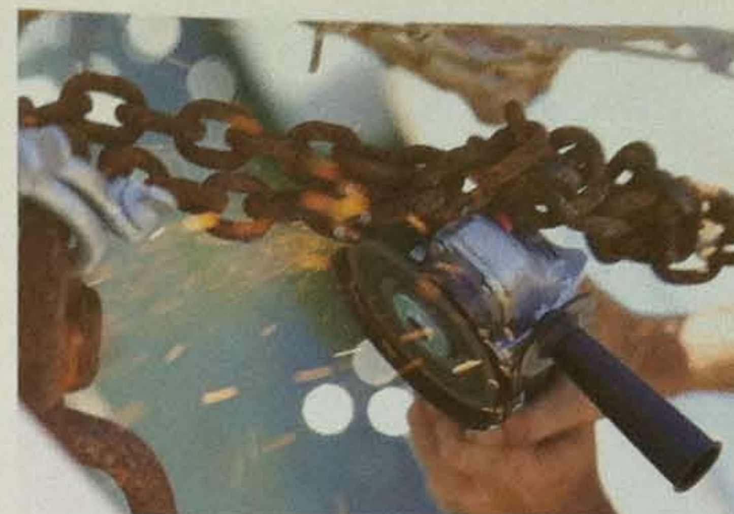
Die alte Kette wird mit einem Scheibenschneider vom Anker getrennt, bevor die neue in den Bug gezogen wird.
